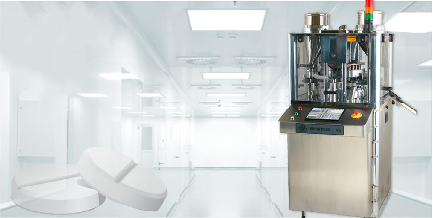
Esta máquina ha sido construida y diseñada según normas GMP permitiendo la fabricación de comprimidos doble y simple capa. Sus ruedas de precompresión y compresión son móviles, permitiendo realizar ajustes individuales para cada una, muestreo y arranque con torque progresivo entre otras prestaciones.
